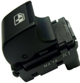
Переключатель стеклоподъёмника предназначен для коммутации электрических цепей электродвигателя привода стеклоподъёмника пассажирских дверей автомобиля. Климатическое исполнение «У,Т» по ГОСТ 15150-69. Выпускаются по Ф5.3709.008 ТУ.
